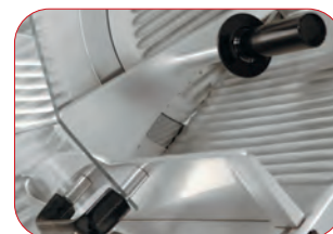
Protecciones de seguridad.
