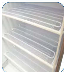
Refrigeración estática mediante estantes evaporadores
